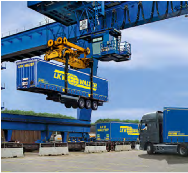
Beim kombinierten Verkehr kommt der gesamte Sattelaufleger auf den Zug, nicht nur ein Container.
